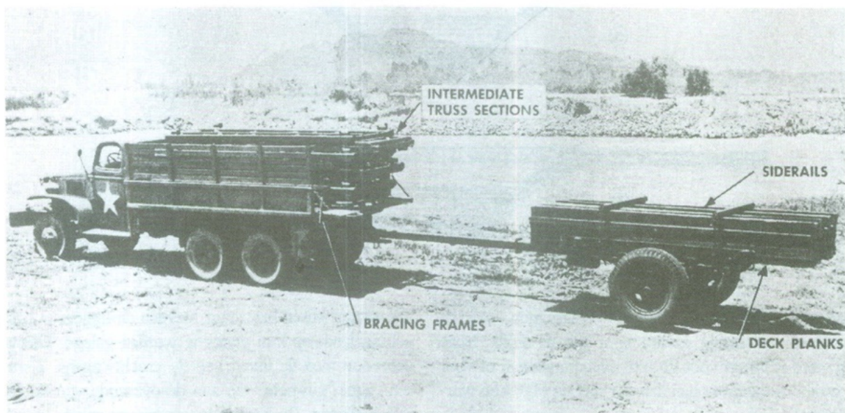
Een 2½ ton GMC+ aanhangwagen, beladen met inklapbare ("knock-down") intermediate truss sections, dekplanken en siderails. Deze inklapbare truss sections werden gebruikt vanaf begin 1944.
